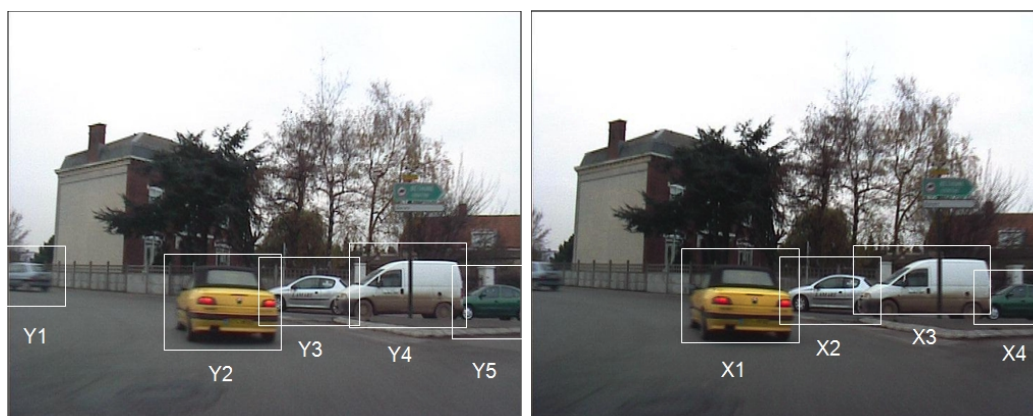
(a) Véhicules détectés à l'avant d'un véhicule à un instant t (objets connus). (b) Véhicules détectés à l'avant du véhicule un instant plus tard t' > t (objets perçus).
